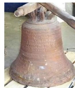
Nota : Le fabricant français de cloches en acier, Jacob Holtzer & Cie à Unieux (le seul fournisseur de cloches en acier sur le territoire, mis à part quelques rares cas de cloches provenant d'Allemagne), passait sur la surface « *un liquide à base de cuivre* » avant la livraison (sans avoir indiqué précisément la composition de ce liquide).
